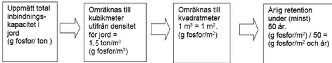
Figur 11. Ansats för hur total inbindningskapacitet i mark kan omräknas till årlig retention per kvadratmeter och år.
